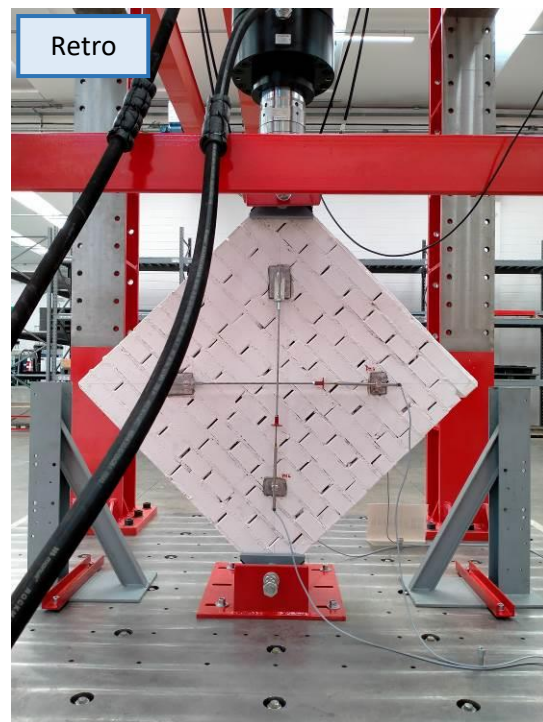
Fotografia 10: Campione C01 - nessun rinforzo dopo la prova
