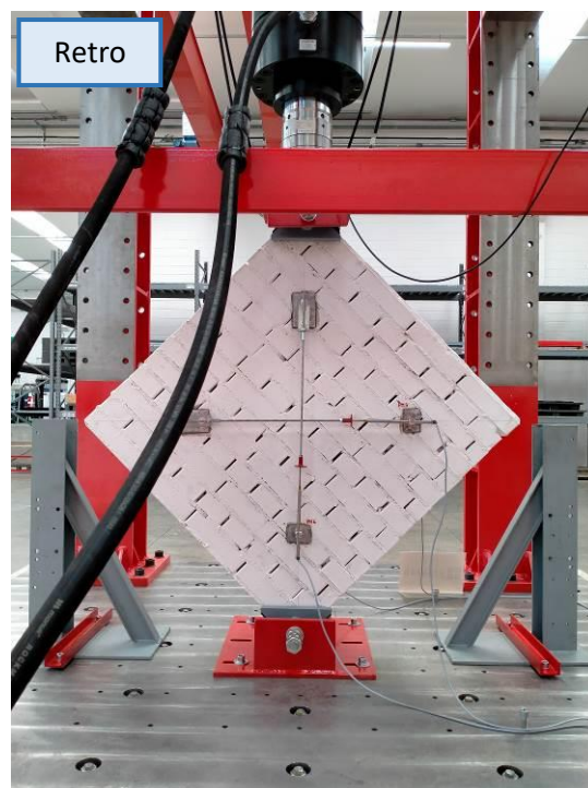
Fotografia 10: Campione C01 - nessun rinforzo dopo la prova
