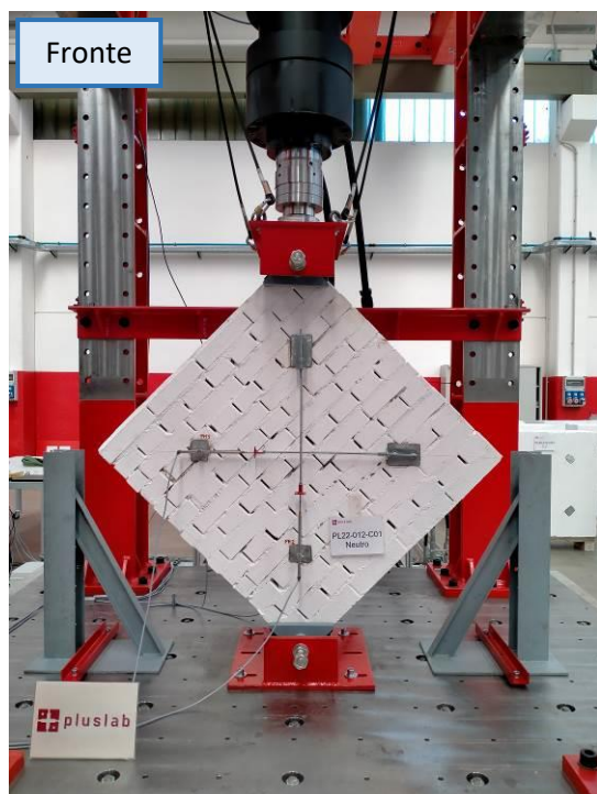
Fotografia 10: Campione C01 - nessun rinforzo dopo la prova
