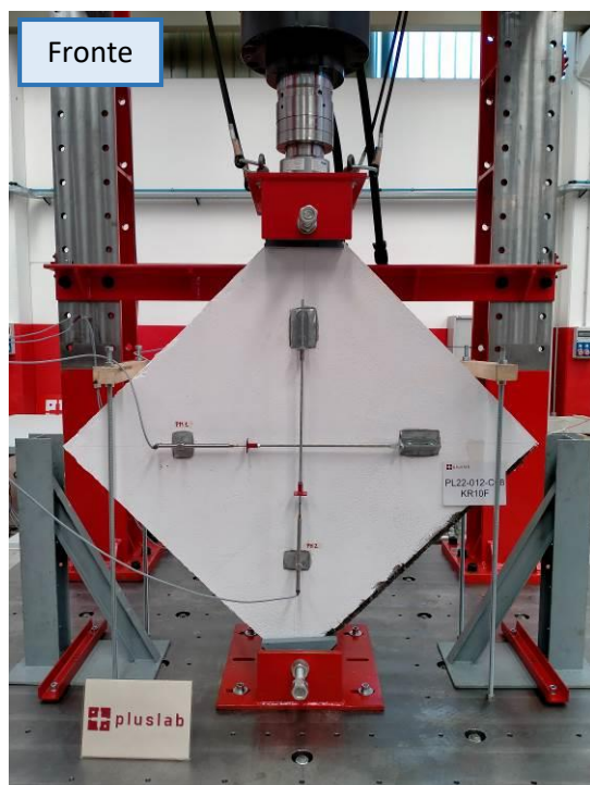
Fotografia 16: Campione C04 – RESTAURMIX-KR10F dopo la prova
