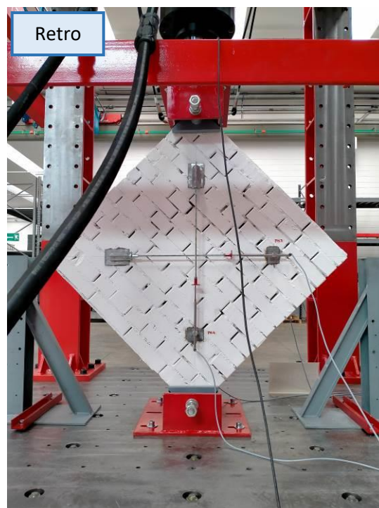
Fotografia 12: Campione C02 - nessun rinforzo dopo la prova
