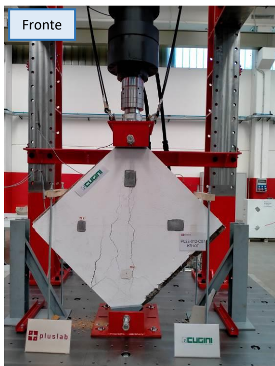
Fotografia 14: Campione C03 – RESTAURMIX-KR10F dopo la prova
