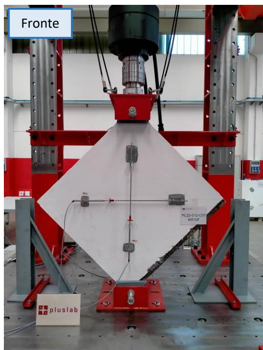
Fotografia 14: Campione C03 – RESTAURMIX-KR10F dopo la prova
